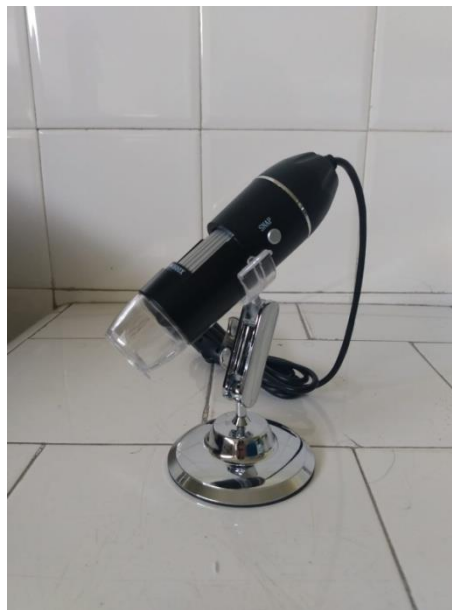
Figura 9. Microscópio digital portátil USB.
