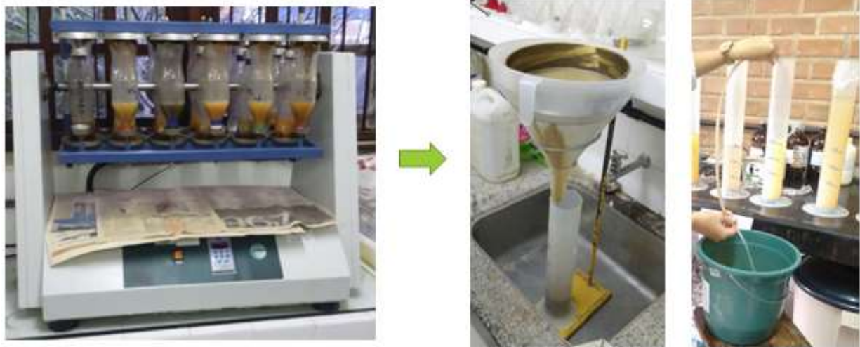
Figura 2 – Processo de separação de frações dos solos, afim de obter a fração argila.
