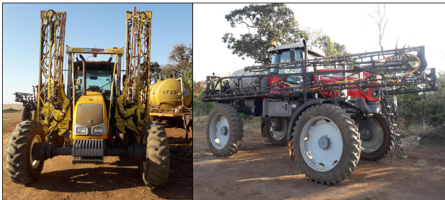
Figura 13. Pulverizadores de barra. À esquerda Herbi Plus G3 S com capacidade para aplicação de 1500L de calda. À direita uniporte Massey Ferguson 9030 com capacidade para aplicação de 3000L de calda.
