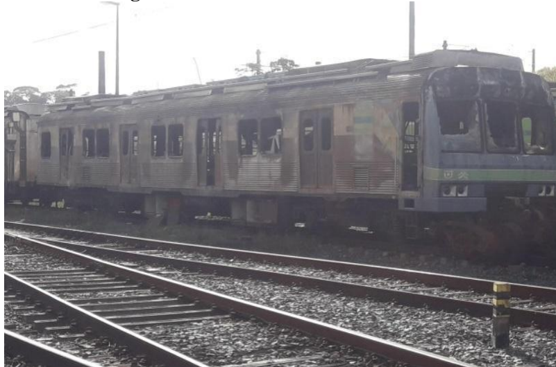
Figura 7- Metrô do Recife canibalizado
