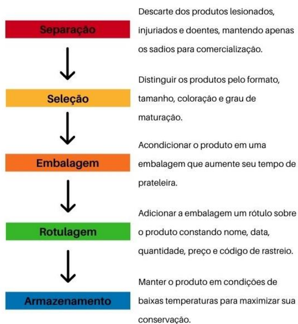
Figura 6 – Fluxograma do processo pós-colheita de hortifrutis.
