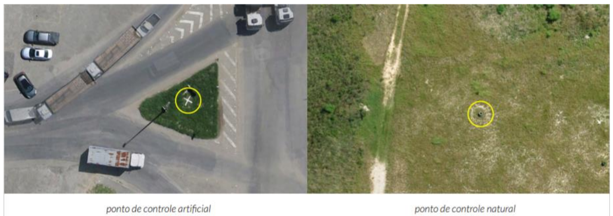
Figura 13 Pontos de controle artificiais e naturais Fonte: (Kugler, 2008).
