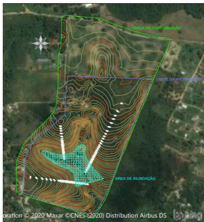
Figura 24 Area inundada superficie com drone Fonte: Autor
