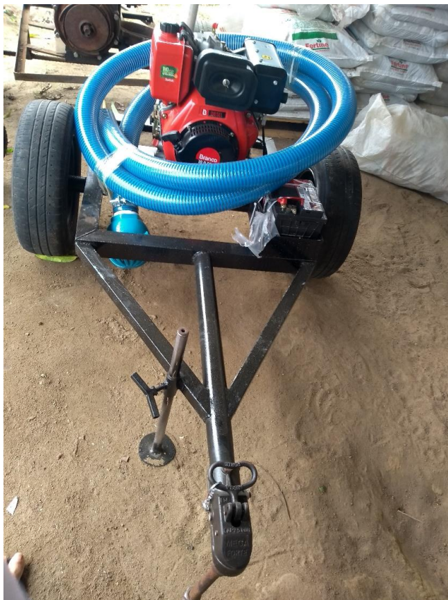
Imagem 16: Motobomba a diesel (10cv)
