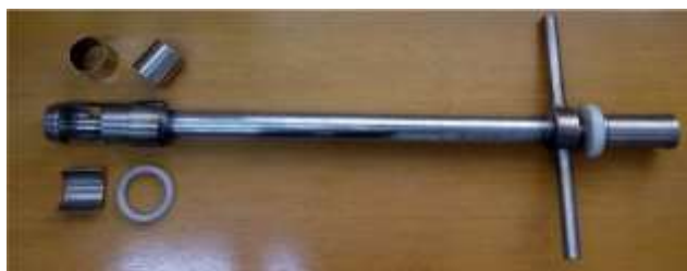
Figura 5 – Trado tipo Uhland e anéis volumétricos de 100 cm 3 para coleta indeformada de amostra de solo
