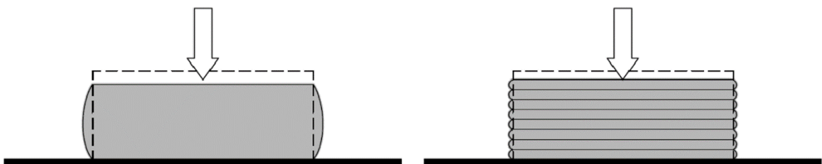
Figura 11 - Comparação entre o comportamento de blocos de elastômero não-fretado e fretado.
