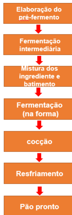
Figura 4 - Fluxograma da preparação dos pães sem glúten.
