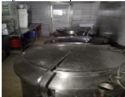
Figuras 5: Painela de pressão industrial
