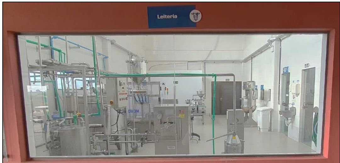
Figura 2. Vista da leiteria apresentando pasteurizador, máquina de envase de leite, câmara fria, tacho com agitador, barreira sanitária, sala de equipamentos e utensílios.
