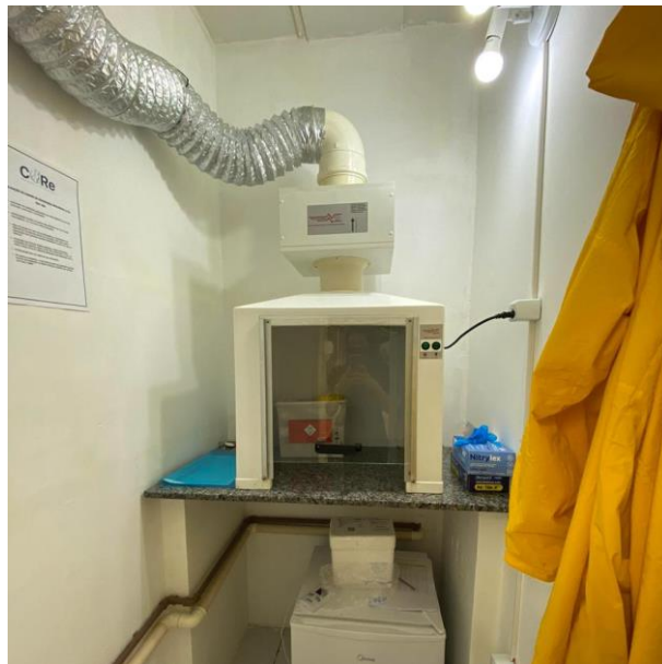
Figura 23: Anexo contendo capela de fluxo laminar reservado para manipulação de quimioterápicos. Fonte: Arquivo pessoal (2022).
