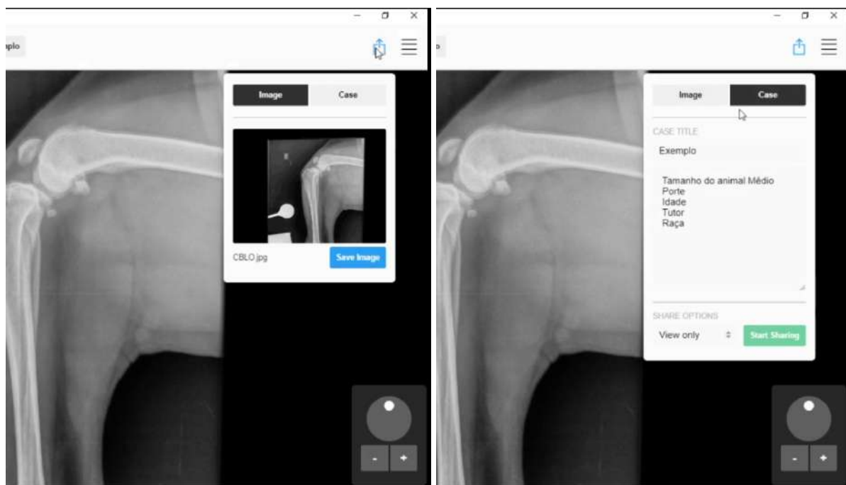
Figuras 28 e 29: (28) Observa-se a aba “Image” que é utilizada para a exportação do planejamento cirúrgico em formato de .jpg, permitindo que seja salvo em seu computador uma imagem do momento que é realizada a exportação desta imagem. (29) Na aba “Case” é possível alterar o nome e notas do caso, assim como compartilhar um link do caso para que através de um navegador de internet possa ser aberto e visualizado o planejamento pré-operatório cirúrgico.
