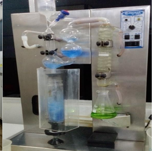
Figura 6. Determinação de proteína bruta. Fonte: Arquivo pessoal (2021). (Divulgação autorizada pela empresa).
