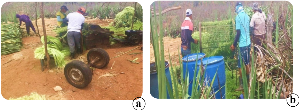
Figura 1. Processamento do sisal na propriedade sisaleira em Barra de Santa Rosa. a) Desfibramento do sisal; b) Peneira rotativa desenvolvida pela Embrapa para obtenção da MUDS. Fonte: Acervo pessoal.
