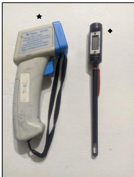
**Figura 9:** Termômetro infravermelho (★) e Termômetro tipo espeto (◆).
