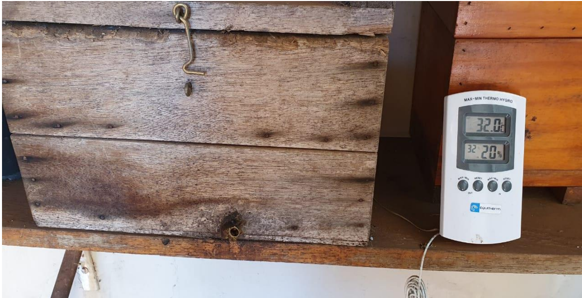
Figura 2. Termo-higrômetro digital utilizado para a coleta dos dados de temperatura ambiente e umidade relativa do ar, em Recife, PE.
