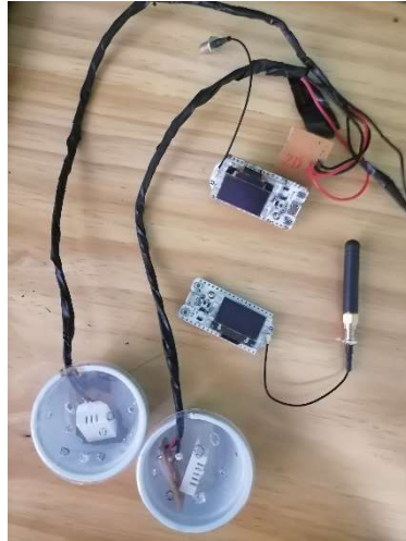
Figura 15. ESP32 Heltec Lora com sensores de temperatura e umidade. Fonte: Arquivo pessoal
