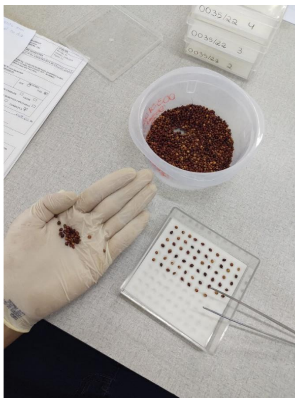
Figura 29. Lançamento de sementes de sorgo em papel mata-borrão para teste de germinação.
