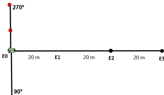
Figura 38 – Alineación de dos puntos en la Sección 0, a través de alineación del Jalón en el hilo vertical del telescopio.
