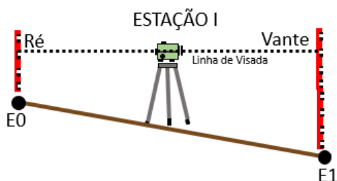
Figura 16 – Nivelamento Geométrico Simples.
