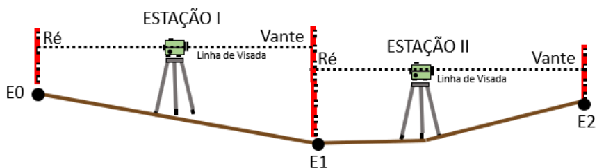
Figura 17 – Nivelamento Geométrico composto.
