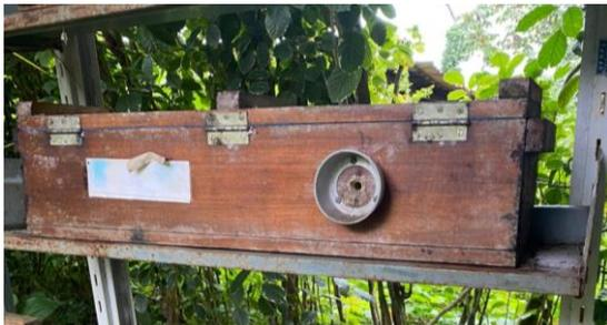
Figura 1 – Caixa utilizada para observação da atividade de voo.
