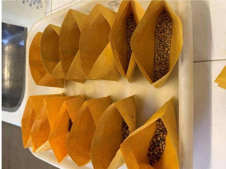
**Figura 8.** Preparação das amostras para pré-secagem em estufa.
