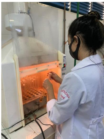
**Figura 15.** Capela e bloco digestor.
