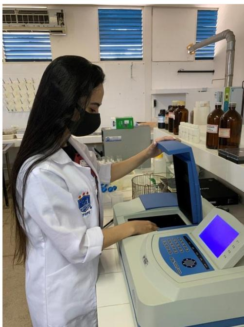
**Figura 19.** Leituras do comprimento de onda das soluções com auxílio do espectrofotômetro.
