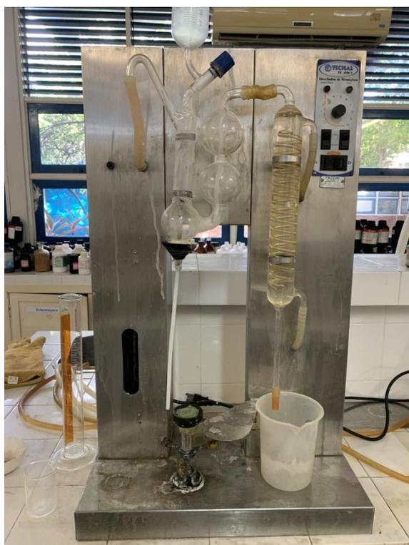
**Figura 16.** Destilador do tipo Kjeldahl.
