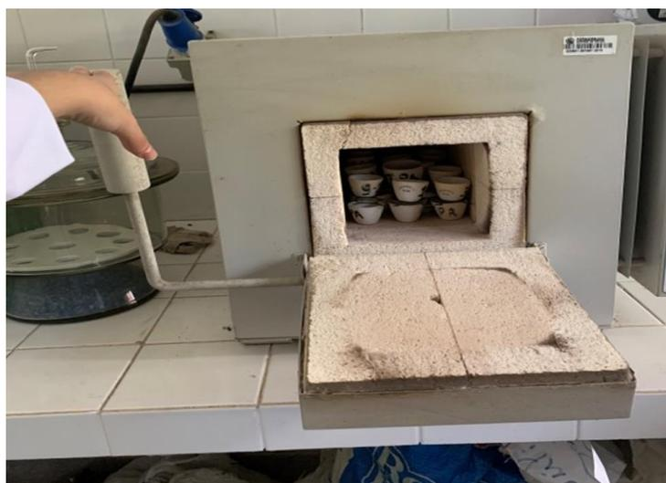
**Figura 14.** Amostras sendo retiradas da mufla após secagem.
