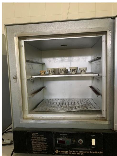
**Figura 12.** Amostra na estufa para determinação da matéria seca (MS).
