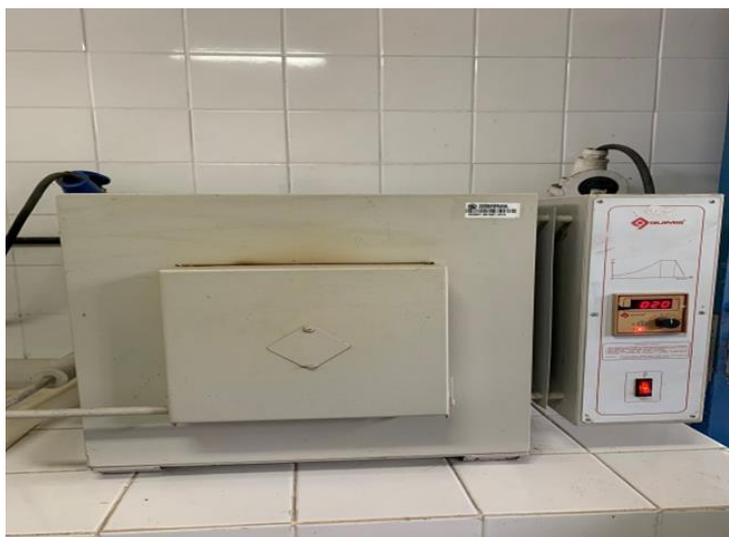
**Figura 13.** Mufla para secagem dos materiais.
