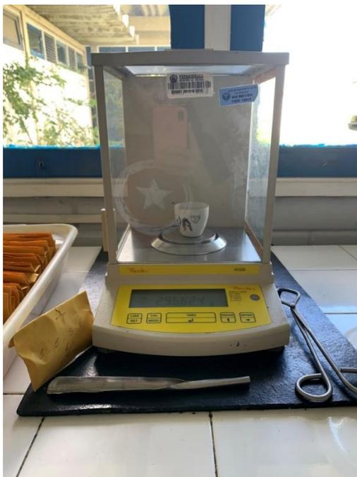
**Figura 11.** Balança analítica para pesagem do material.
