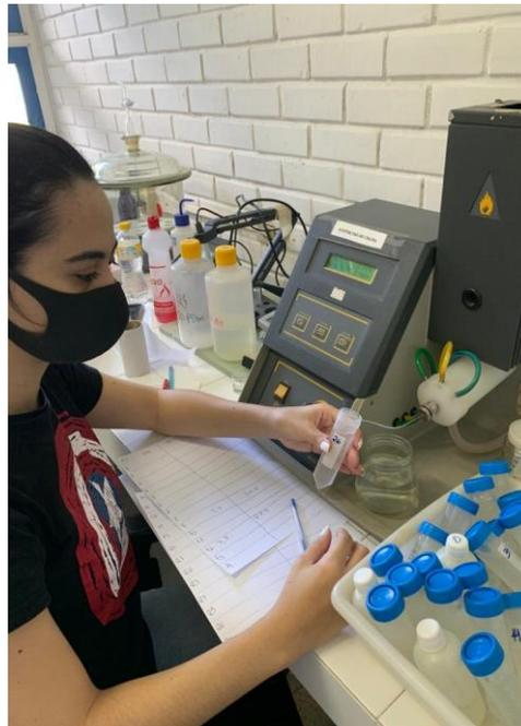
**Figura 22.** Leituras de  $\text{Na}^+$  e  $\text{K}^+$  com fotômetro de chamas.
