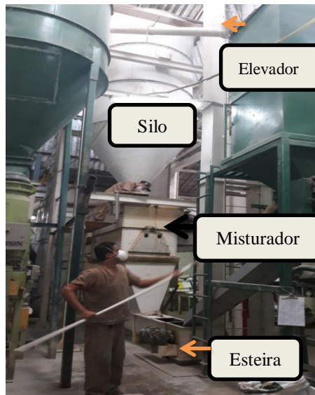
Figura 16. Misturador, silo e esteira , para rações melaciadas. Fonte: Acervo pessoal.
