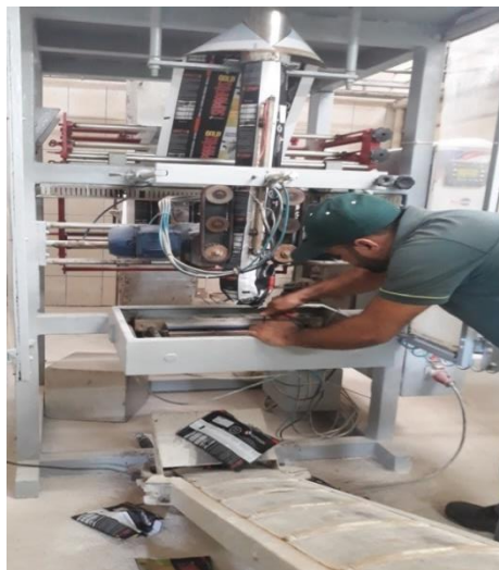
Figura 29. Manutenção, lubrificação de engrenagens da empacotadeira raumak. Fonte: Acervo pessoal.
