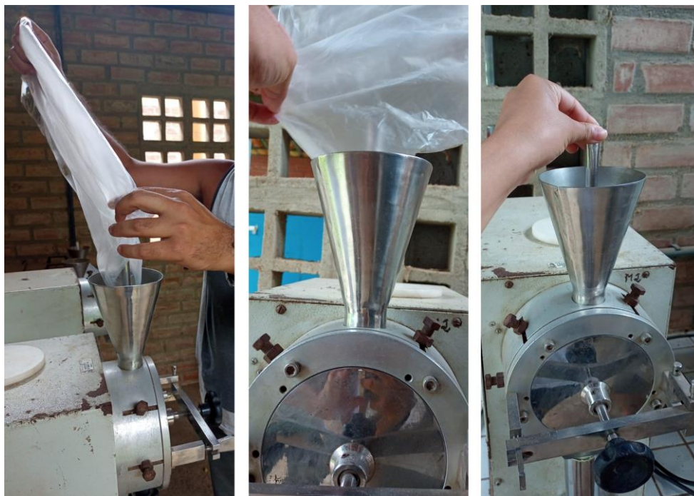
Figura 20. Amostra passando no moinho tipo Willey após passar 72h em estufa de circulação forçada
