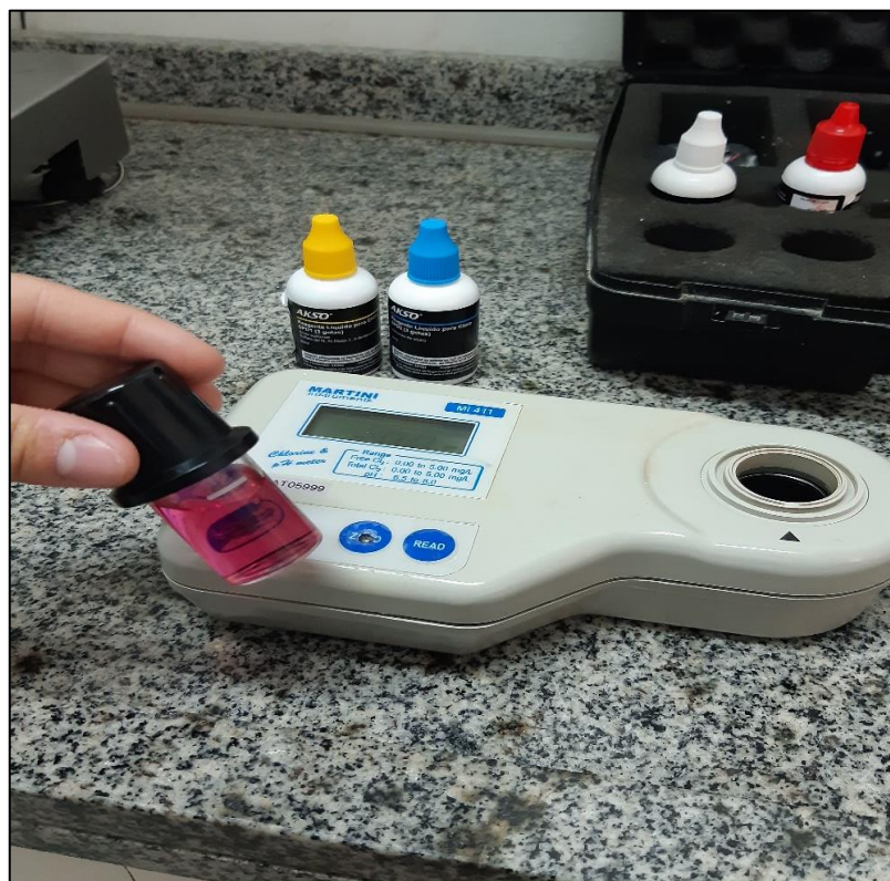
Figura 7. Clorímetro digital medidor de cloro e pH. Fonte: Lima (2020).
