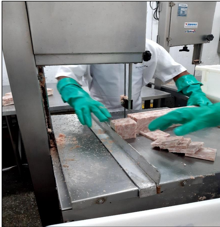
Figura 21. Serragem de blocos de Polaca do Alaska. Fonte: Lima (2020).
