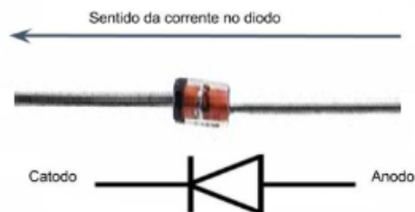
Figura 5: Componente eletrônico - diodo, e abaixo sua simbologia.
