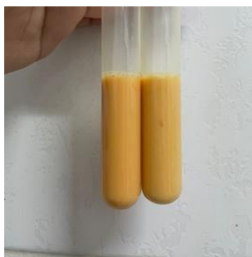
Figura 21 Resultado fraco positivo para o teste de cloretos.
