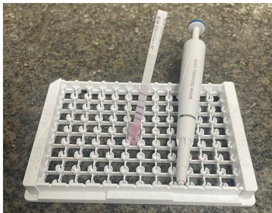
Figura 19 Fita reagente demonstrando resultado negativo.
