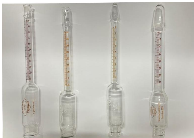
Figura 11 Butirômetros de diferentes volumes utilizados para diferentes produtos, da esquerda para a direita estão butirômetro de manteiga e queijo manteiga; demais queijos e requeijões; leite e soro de leite; e creme de leite.
