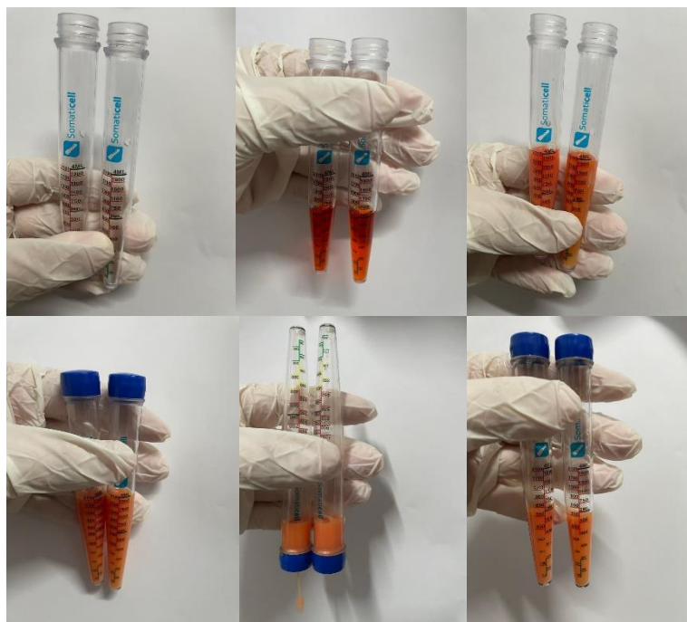
Figura 14 Esquema de preparação do teste de CCS.
