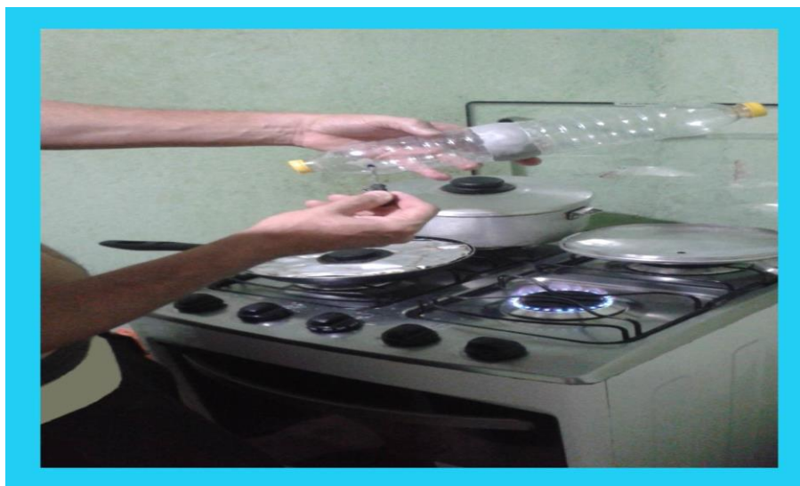
Figura 19 – Perfuração dos recipientes já colados com durepóxi
