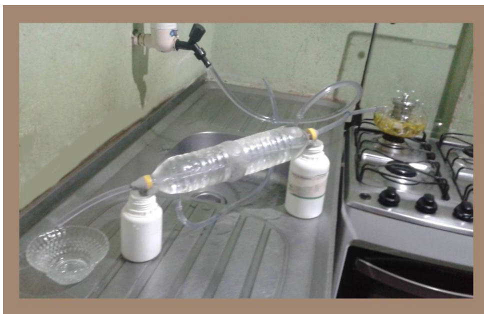
Figura 26: Aparelhagem completa para iniciar a destilação
