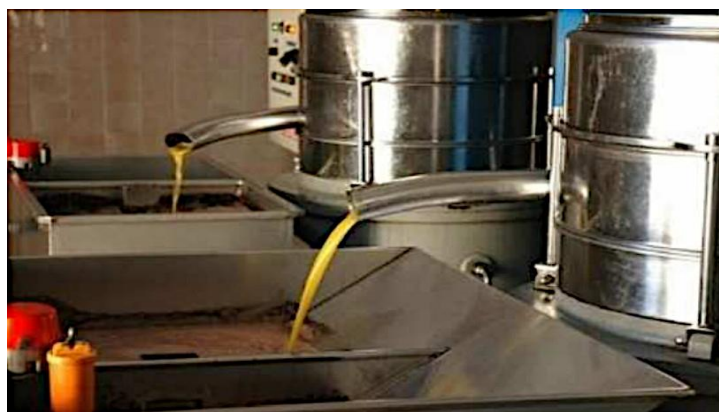
Figura 12 - Processo de extração de óleo essencial por prensagem a frio
