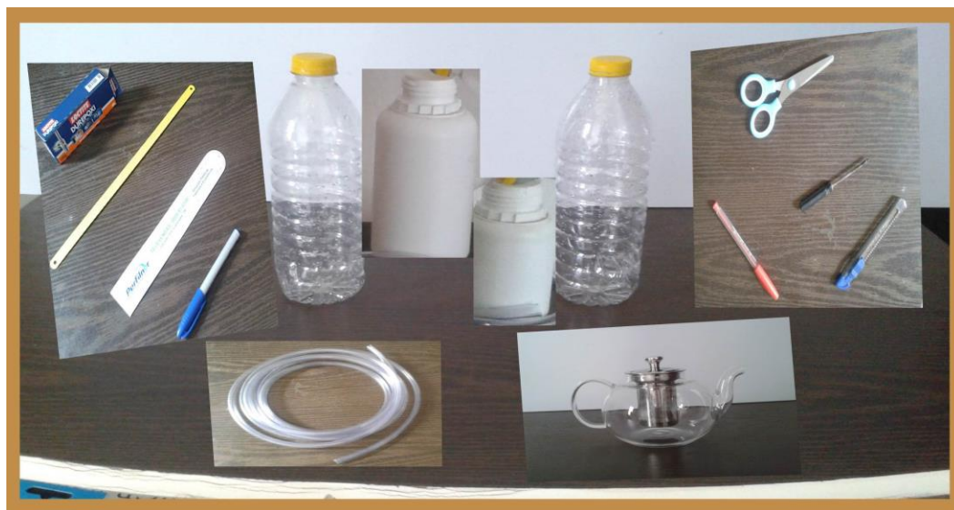
Figura 14 – Materiais utilizados para construir o condensador alternativo
