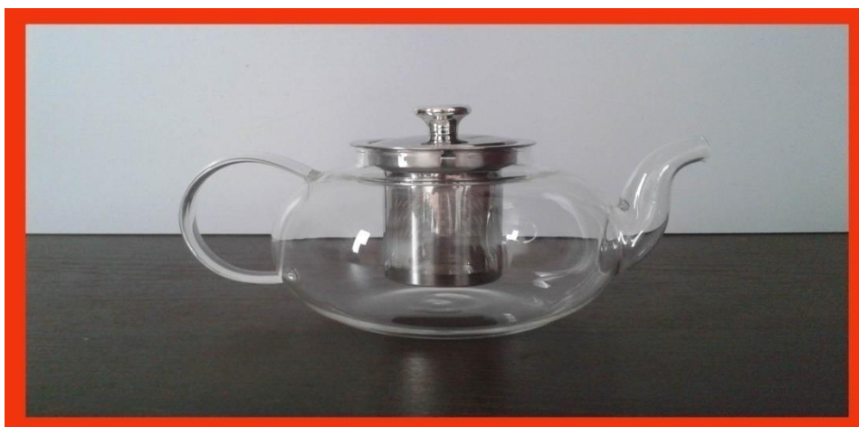
Figura 21 – Chaleira de vidro utilizada como balão destilação
