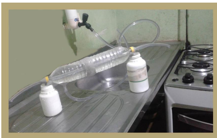
Figura 24: Condensador pronto para destilação
