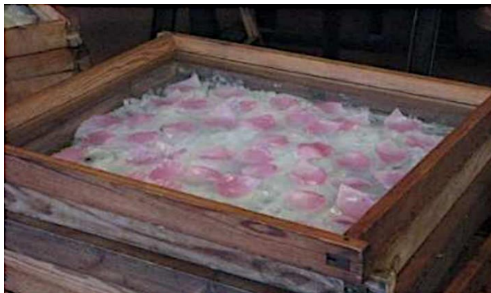
Figura 11 - Processo de extração de óleo essencial por enfleurage
