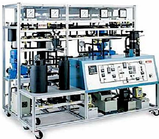
Figura 10 - Planta de extração de óleo essencial por fluido supercrítico
