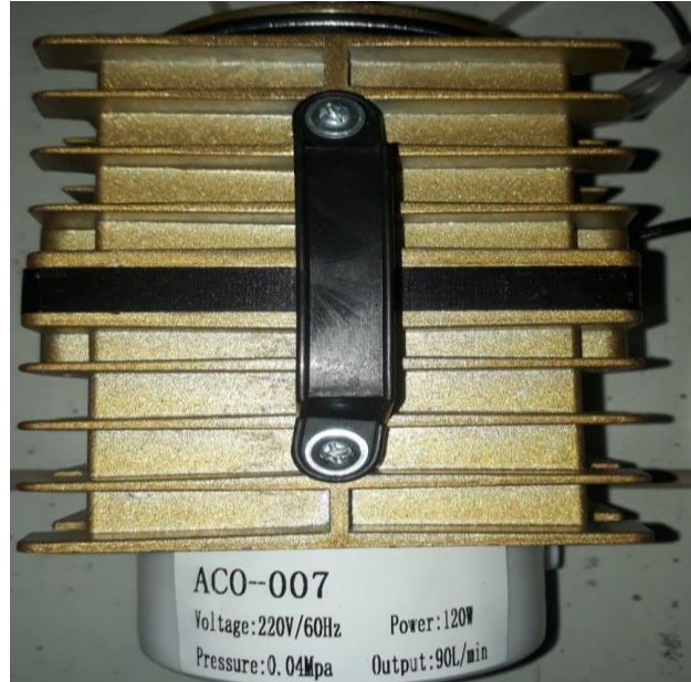
Figura 25. Aerador, 90 litros/minuto, instalado no sistema.
