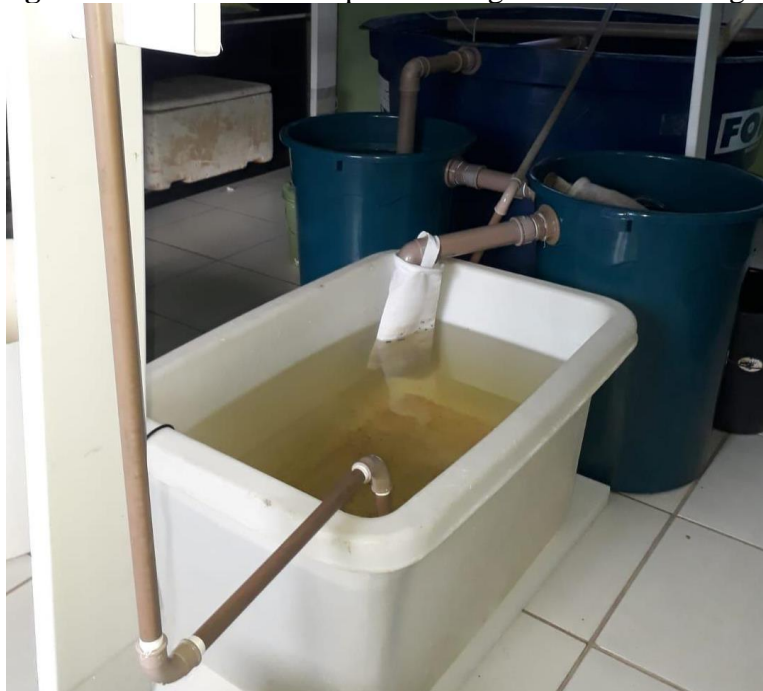
Figura 20. Caixa utilizada para montagem do filtro biológico.
