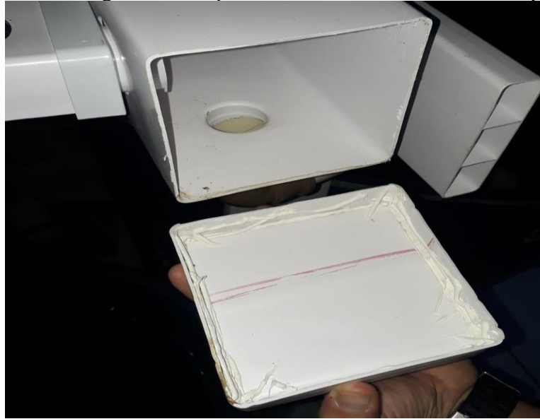
Figura 32. Colagem das tampas dos coletores da bancada hidropônica.
