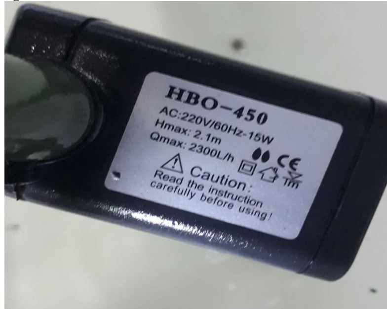
Figura 22. Bomba HBO - 450, com vazão de 2.300 litros/hora.
