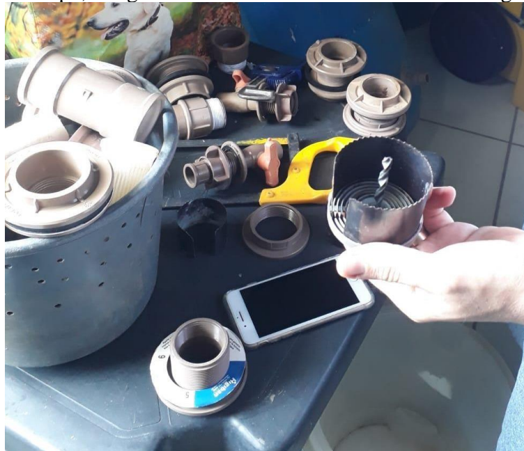
Figura 16. Serra copo, flanges e outros materiais utilizados na montagem do sistema.
