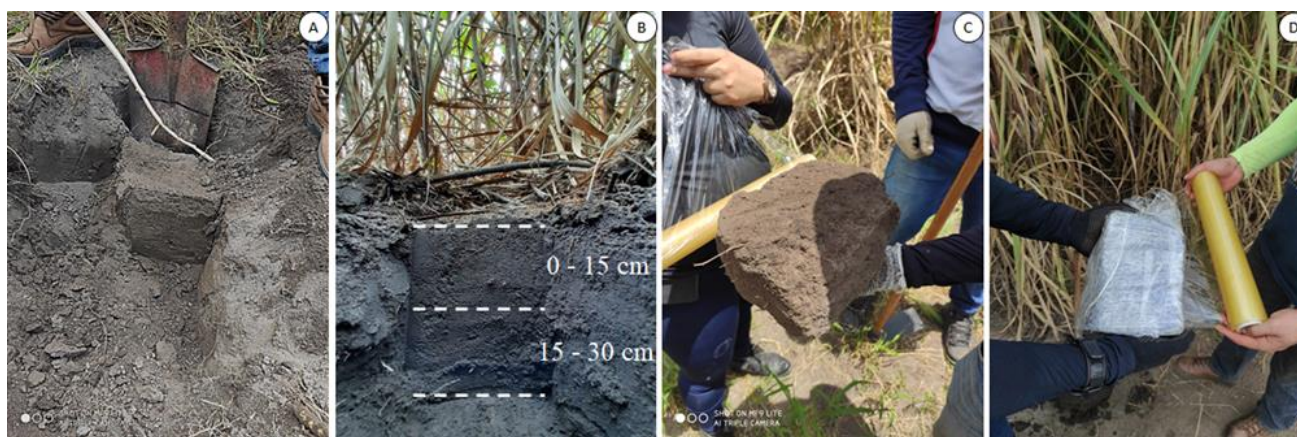
Figura 1 - Coleta de amostras de solos estruturados. (A) e (B) Abertura das mini trincheiras, para remoção dos blocos; (C) e (D) Blocos de solos, e processo de empacotamento para proteção da estrutura (plástico filme). Fonte: O Autor.
