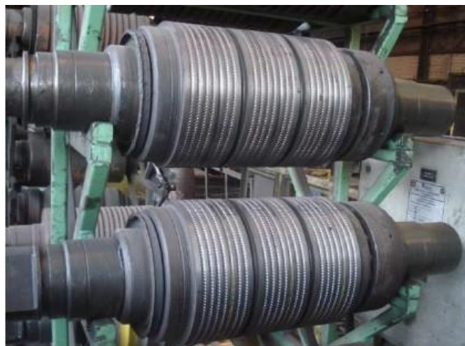
Figura 7 – Cilindros de laminação com canais usinados
