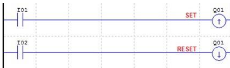
Figura 24 – Linha de programação Ladder para as instruções SET e RESET
