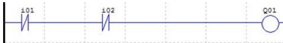
Figura 23 – Linha de programação Ladder da função NOR
