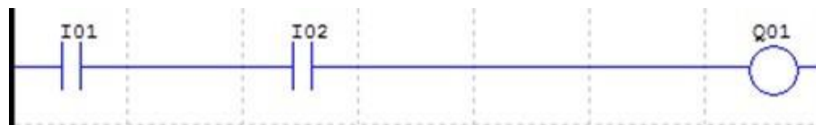
Figura 20 – Linha de programação Ladder da função AND
