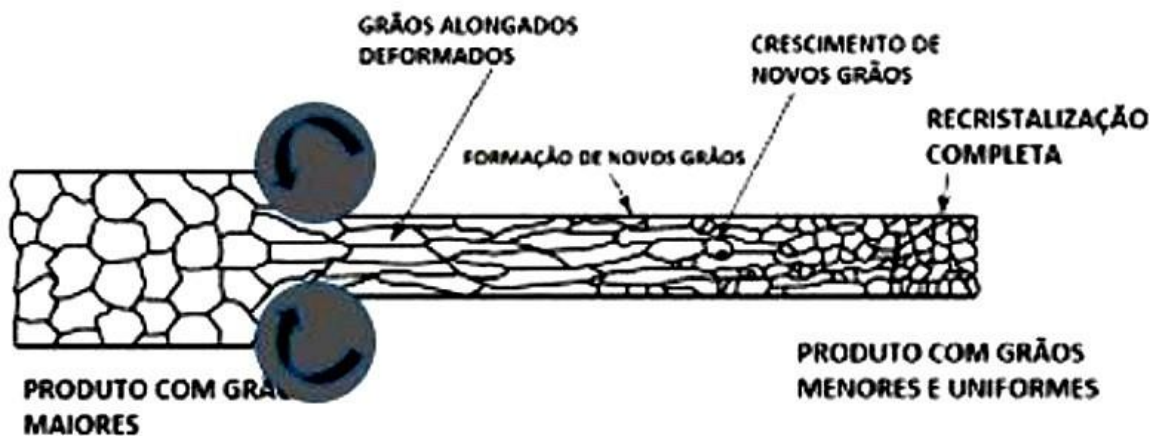
Figura 9 – Esquema de conformação mecânica realizada pelos cilindros de laminação
