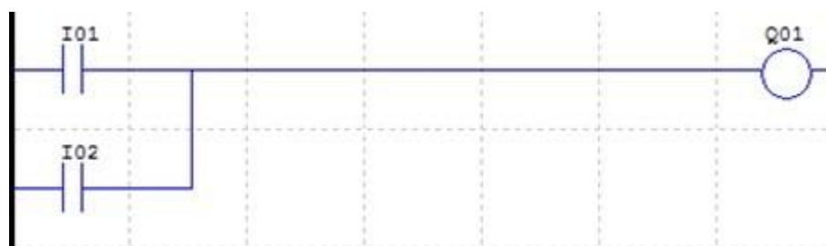
Figura 21 – Linha de programação Ladder da função OR
