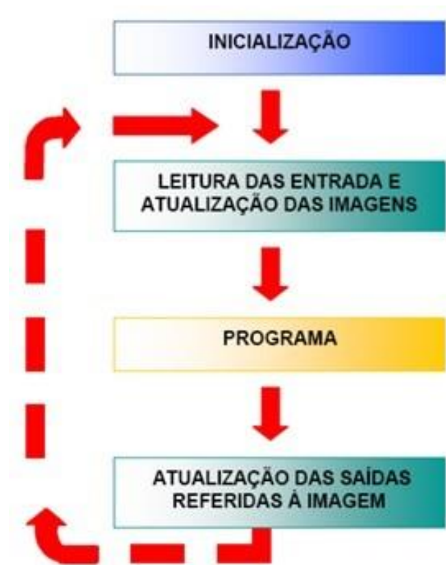
Figura 17 – Ciclo de processamento do CLP
