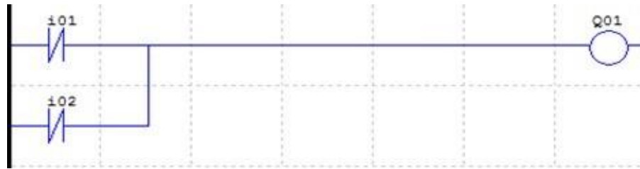
Figura 22 – Linha de programação Ladder da função NAND
