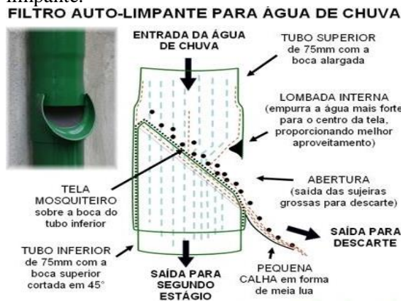
Figura 2 – Funcionamento do filtro auto-limpante.
