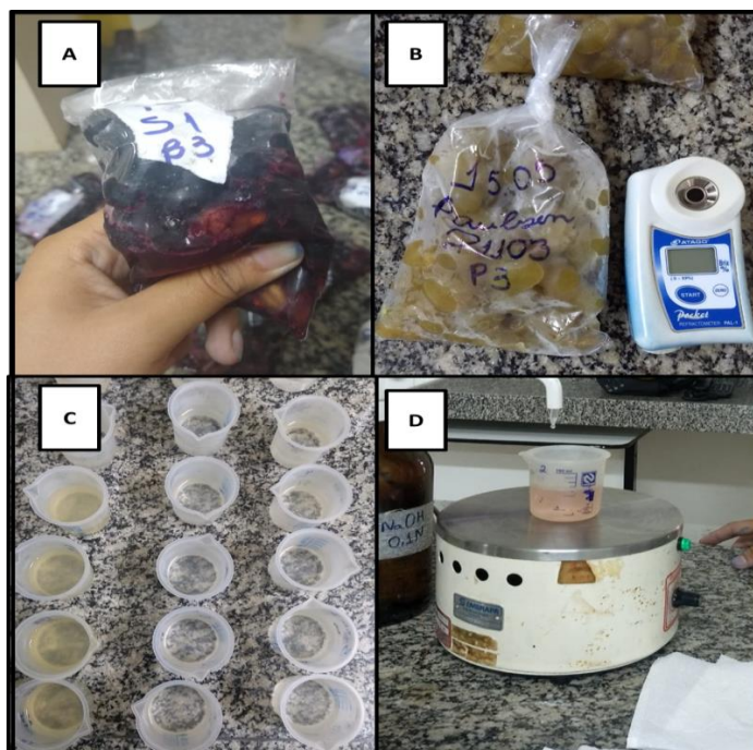
Figura 6. Esmagamento das bagas para obtenção de suco (A), medição do teor de sólidos solúveis (°Brix) (B), solução para determinar a acidez titulável (C) e ponto de viragem da amostra para acidez titulável (D). EMBRAPA Semiárido.
