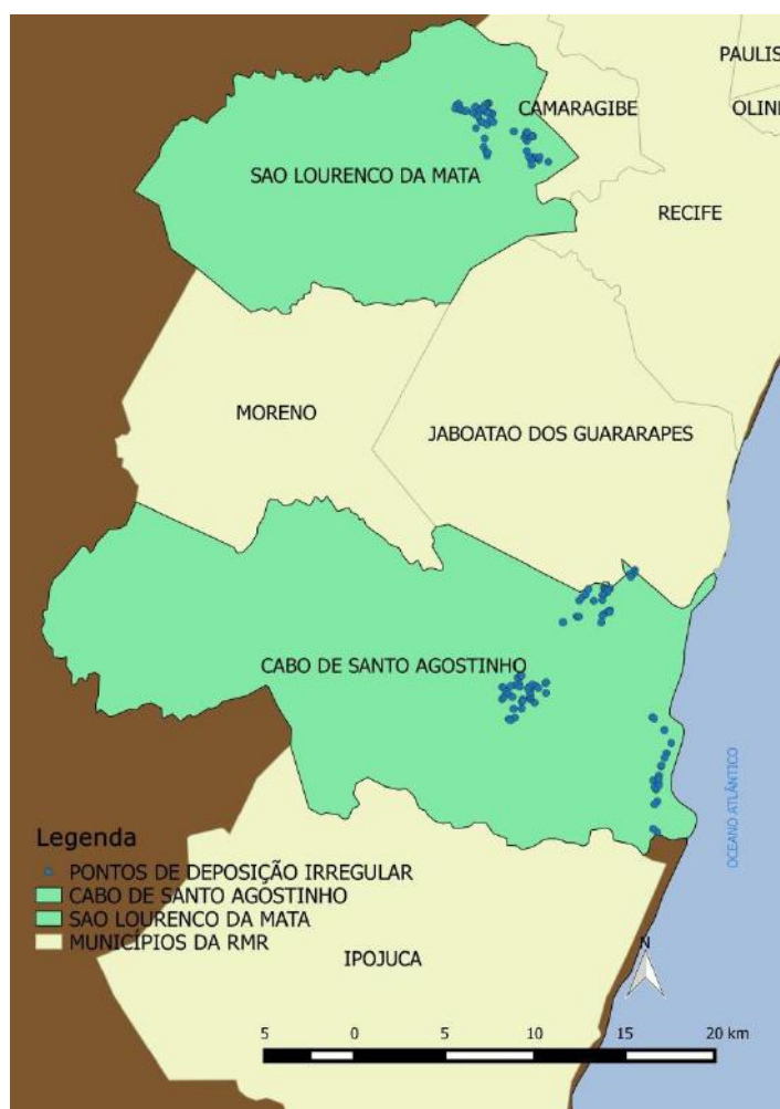
Figura 2. Pontos de deposição irregular de RCD em Cabo e Santo Agostinho e São Lourenço da Mata, PE.
