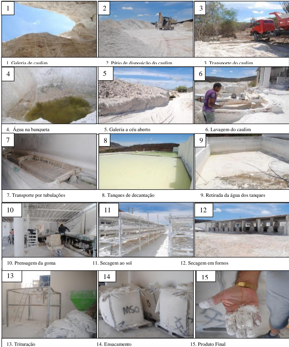
Figura 03. Processo de extração e beneficiamento do Caulim
