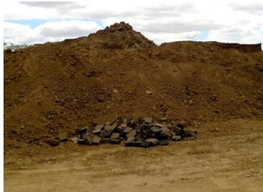
Figura 3- Resíduos da preparação ou mistura até o processo de secagem reintroduzidos no sazonalização das argilas
