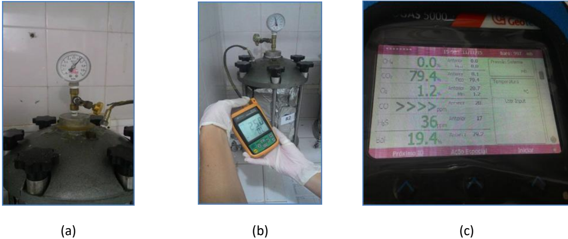
Figura 4- Monitoramento da pressão de biogás gerada (a), temperatura (b) e análise qualitativa do biogás (c).
