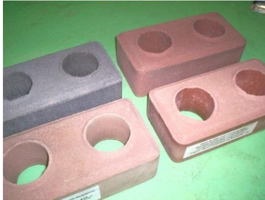
Figura 2 - Tijolo Ecológico produzido com lodo de ETE
