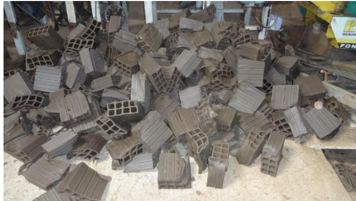
Figura 6- Material com imperfeições após a saída da boquilha da extrusora
