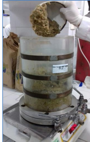
Figura 2- Preenchimento de biodigestor anaeróbio.
