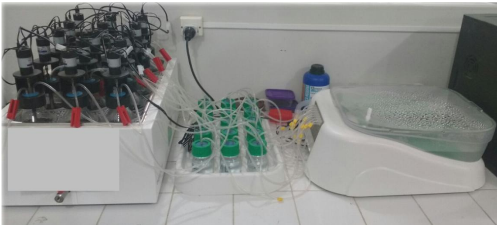
Figura 1: Aparato experimental utilizado (sistema AMPTS II)
