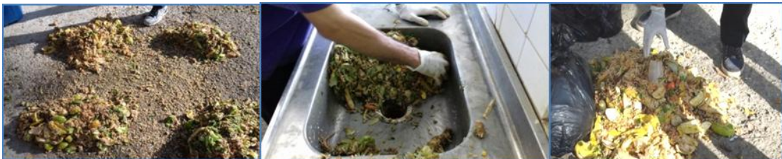
Figura 1- Quarteamento, trituração e triagem da amostra conforme metodologia sugerida pela NBR 10.007 (2004).
