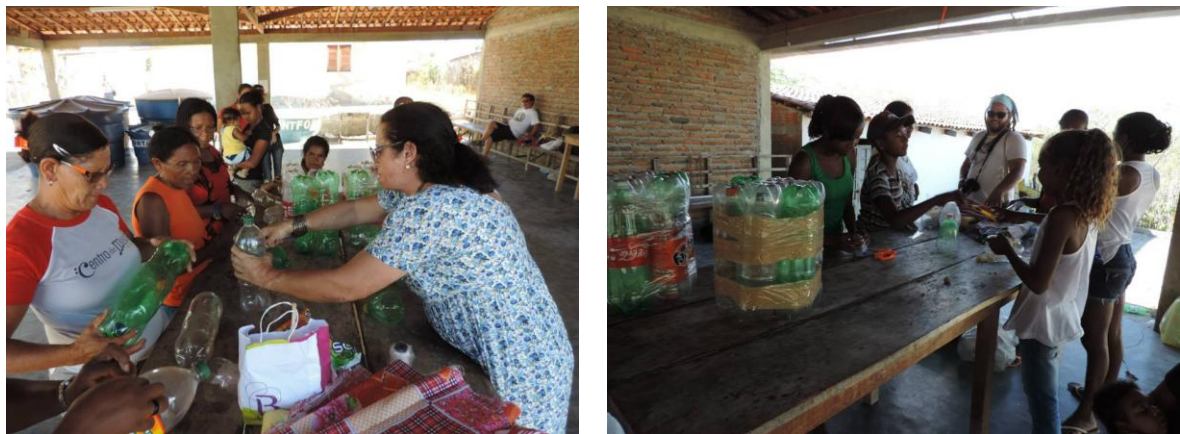
Figura 2 - (A) Encaixe das garrafas e (B) Montagem da base do puff . Fonte: os autores (2017).
