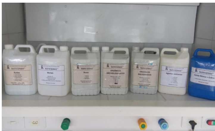
Figura 1 - Bombonas para estocagem provisória dos rejeitos. Fonte: as autoras (2017).
