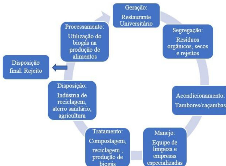
Figura 3. Proposta de fluxograma dos resíduos sólidos do restaurante universitário, utilizando o método da economia circular
