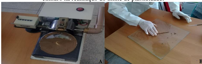
Figura 6. A. Aparelho Casagrande contendo solo para determinação do limite de liquidez. B. Formação do cilindro na realização do limite de plasticidade.
