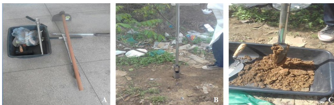
Figura 4. A. Equipamentos utilizados para coleta do solo; B. Coleta sendo realizada na área do lixão da cidade de Pinheiro – MA; C. Material coletado.
