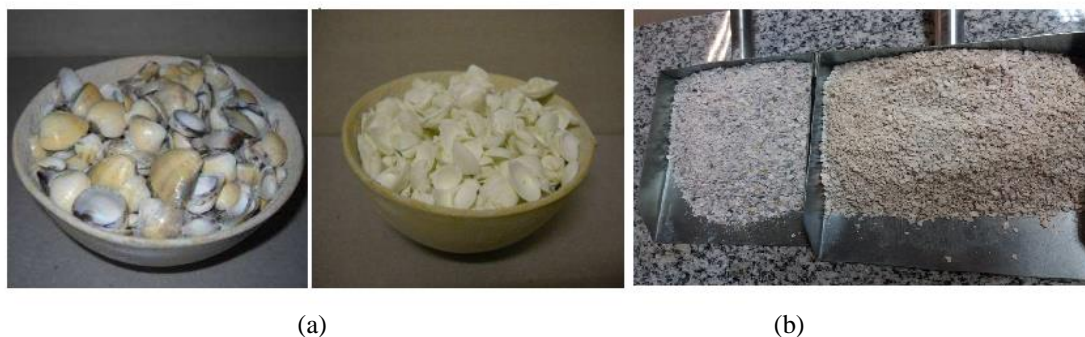
Figura 2 – Transformação da concha de sarnambi em cal virgem. (a) Imagem de antes (esquerda) e depois (direita) do estudo de Santos (2013). (b) Imagem de antes (esquerda) e depois (direita) encontrado na presente pesquisa
