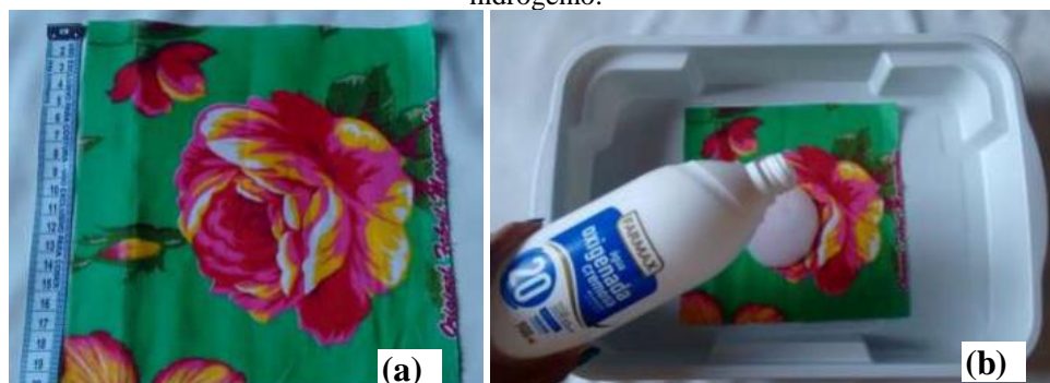
Figura 1. (a) Amostra do tecido chita 200x200 mm e (b) imersão do corpo de prova em peróxido de hidrogênio.
