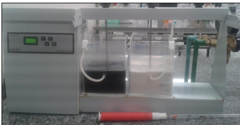
Figura 3. Imagem do equipamento Jar-test para o ensaio de coagulação.
