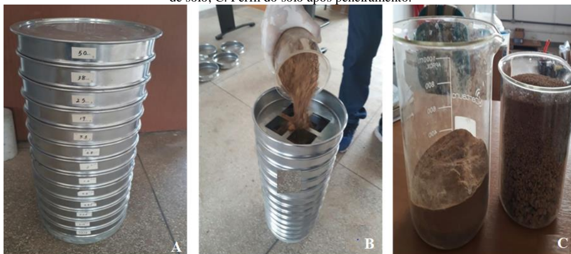
Figura 5. A. Peneiras com as aberturas das malhas crescendo de baixo para cima; B. Peneiramento da amostra de solo; C. Perfil do solo após peneiramento.
