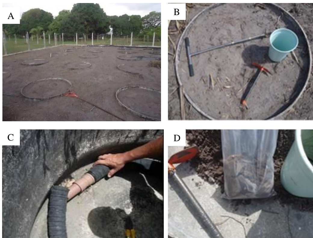
Figura 2. Vista dos Lisímetros (A); Material utilizado para amostragem de solotrado holandês, sancho, balde e sacola plástica (B); sistema de drenagem revestido com manta e tê de redução (C); amostra composta de solo (D). Fonte: Elaborado pelo autor.
