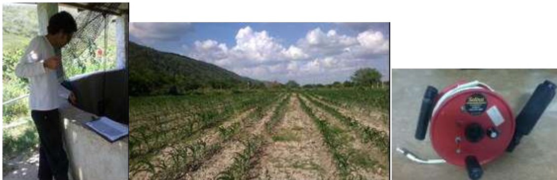
Figura 2- Monitoramento hidrológico em poço comunitário, cultivo de milho em lote irrigado no vale aluvial e trena automática sonora Solinst.
