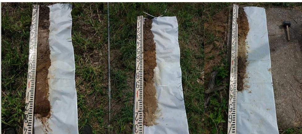
Depois de concluídas as sondagens, foram feitas as medições do lençol freático, respeitando-se um período de tempo de um dia para que houvesse a recarga nos furos produzidos. A partir de medições realizadas com auxílio de medidor de lençol freático e trenas, foram encontrados os valores de profundidade do lençol freático, que, posteriormente, os dados foram repassados para uma planilha do Software Microsoft Office Excel.
