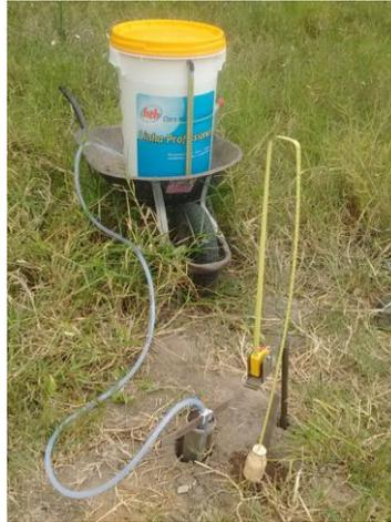
**Figura 07** – Esquema do perfil do solo para a realização do teste de Condutividade Hidráulica para Método do Furo de Trado na Presença do Lençol Freático utilizado no experimento.
