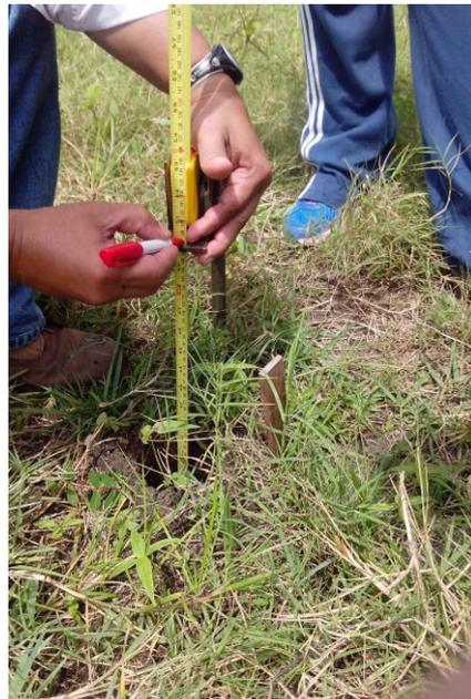
Nos pontos que não apresentaram recarga de água, foram realizados os testes de condutividade hidráulica pelo método de furo de trado na ausência do lençol freático. Neste método utilizaram-se os mesmos instrumentos usados pelo sistema anterior
