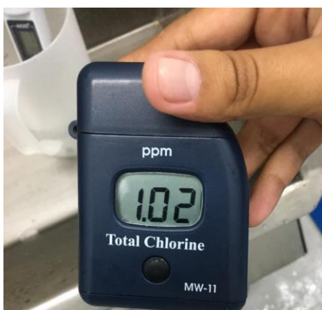
Figura 3 - Medição do cloro na Barreira Sanitária
