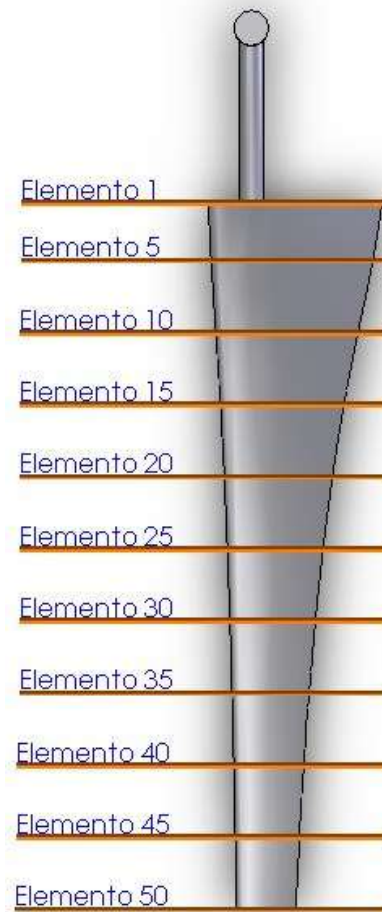
Figura 5 - Pá de turbina discretizada em n elementos
