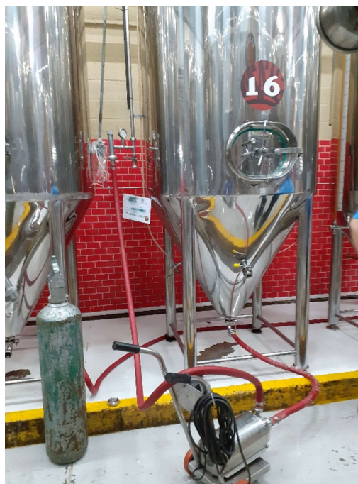
Figura 5. Execução do processo CIP ( Cleaning In Place ).
