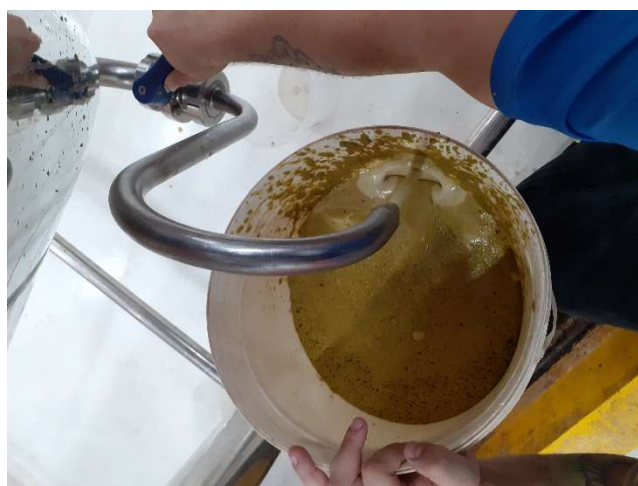
Figura 11. Purga dos tanques de fermentação/maturação.
