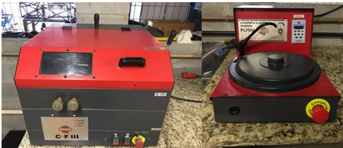
Figura 3 – (A) Cortadeira utilizada no corte dos corpos de prova. (B) Lixadeira e Politriz.
