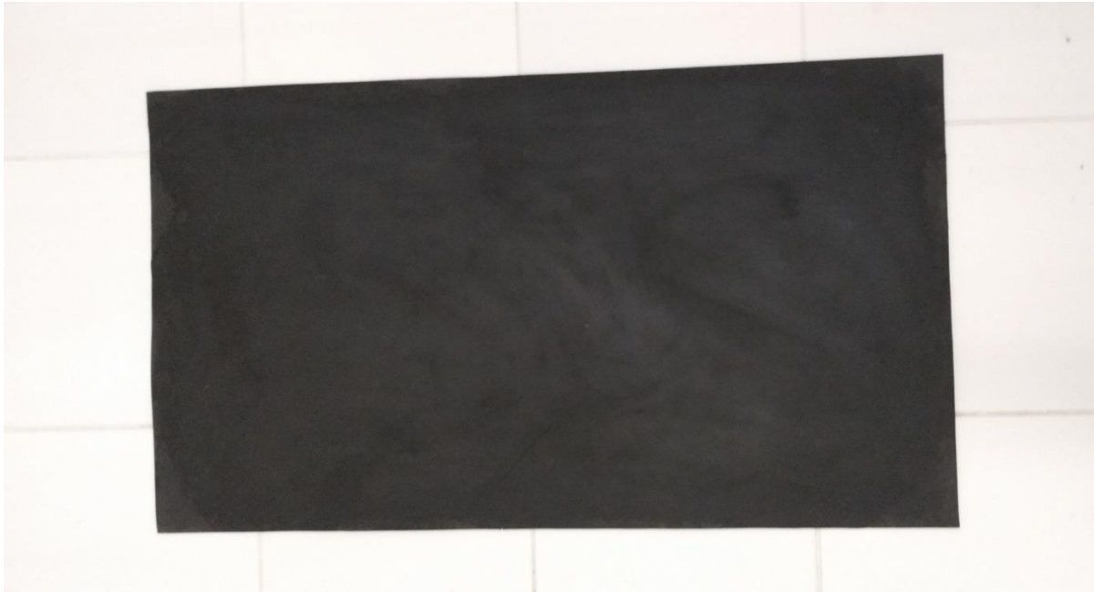
Figura 4: Emborrachado utilizado para revestimento da bancada e para emissão dos termogramas das pegadas. Espessura de 3 milímetros. Arquivo pessoal.
