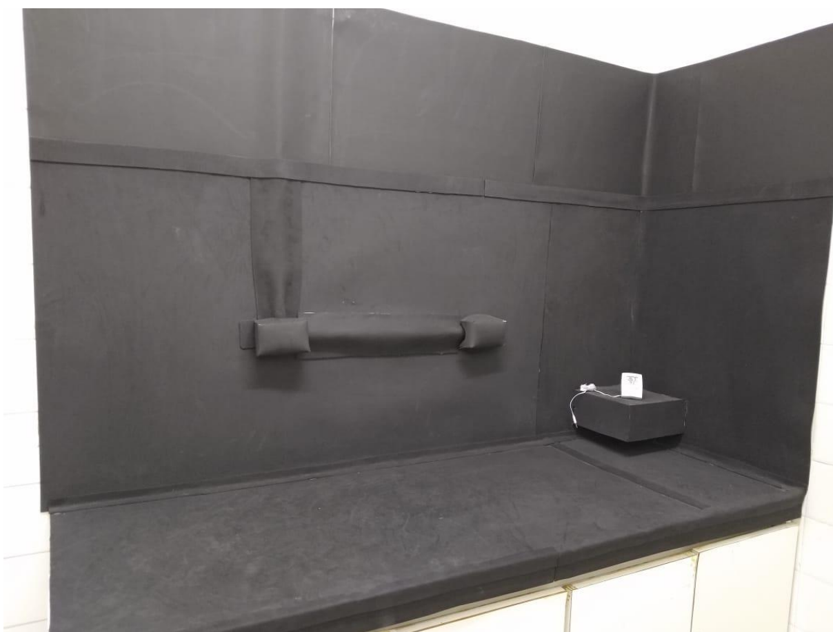
Figura 3: Bancada para realização do exame termográfico, revestida com emborrachado preto. Arquivo pessoal.
