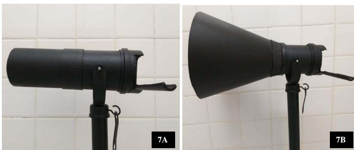
Figura 7A e 7B: Aparelho desenvolvido para diminuir as interferências ao exame termográfico, fixar a distância e ajudar no foco das regiões de estudo. Arquivo pessoal.
