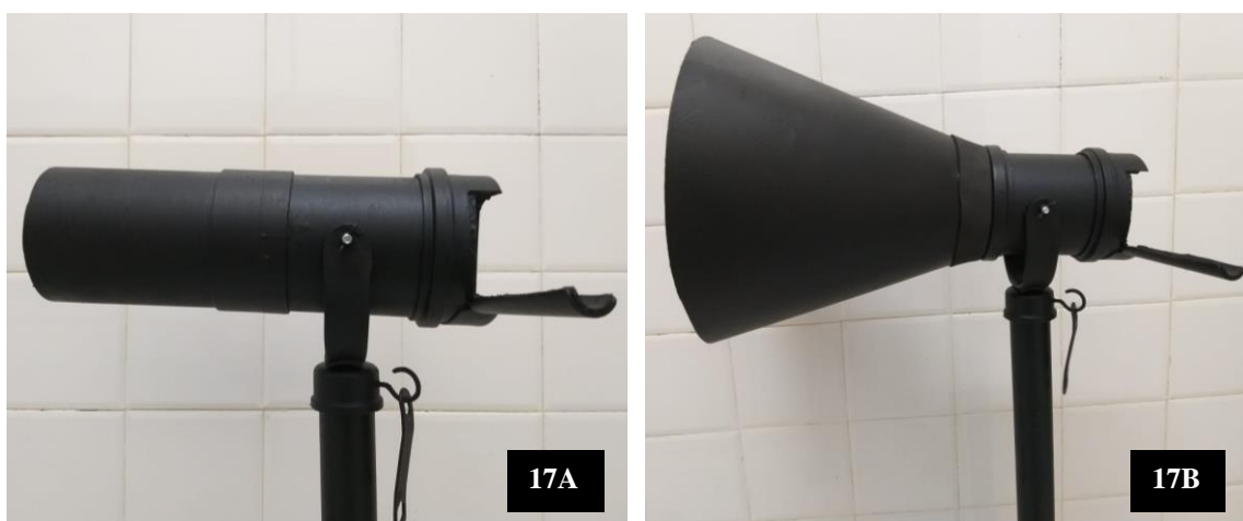
Figura 17A e 17B: Aparelho desenvolvido para diminuir as interferências ao exame termográfico, fixar a distância e ajudar no foco das regiões de estudo. A – foco com menor circunferência usado para regiões pequenas; B – foco com maior circunferência usado para regiões maiores. Arquivo pessoal.
