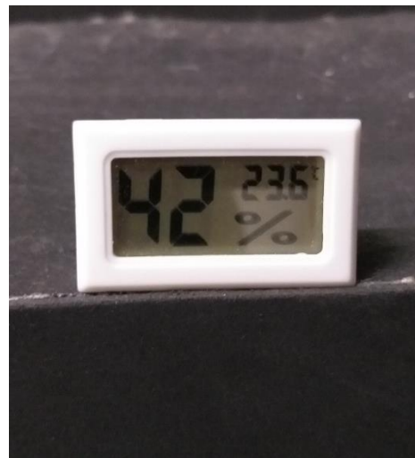
Figura 5: Termohigrômetros utilizados para medir a temperatura ambiente e umidade relativa do ar. Arquivo pessoal.
