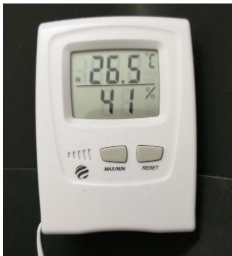
Figura 5: Termohigrômetros utilizados para medir a temperatura ambiente e umidade relativa do ar. Arquivo pessoal.
