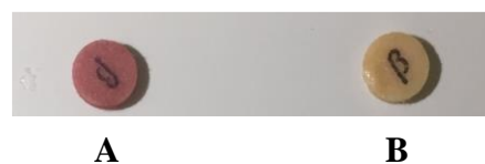
Figura 14. Padrão e alteração de cor dos discos Cefinase para detecção de \beta -Lactamase. A- Reação positiva; B- Reação negativa.
