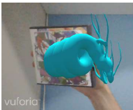
Figura 31 – Falha no rastreamento do Vuforia causando a renderização do objeto virtual em uma posição que não corresponde a forma como este está ancorado ao alvo. Fonte: O autor
